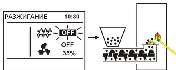
Рис. 2 Выключение шнека при разжигании
