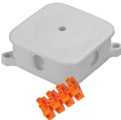
Rys.2.10. Puszka instalacyjna służąca do rozgałęziania połączeń przewodów. Producent PAWBOL, typ P-2 ze złączką pomarańczową 4 x 6mm 2 .
